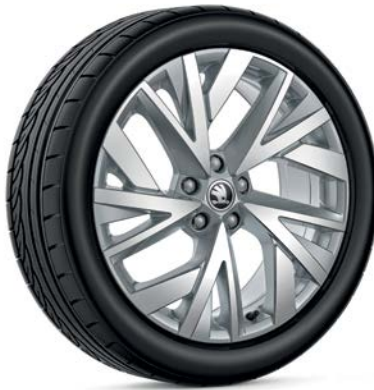
Atria Cerchi in lega 7.5J × 19" ET40 per pneumatici 235/50 R19 57H 071 499 8Z8 | argento metallizzato, spazzolato
